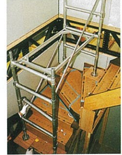
(F) 複雑な階段でもブレースの組み替えて簡単にセットでき安定よく使用できます。
