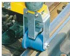
車輪にブレーキ機能を取り付けました。(業界初)
