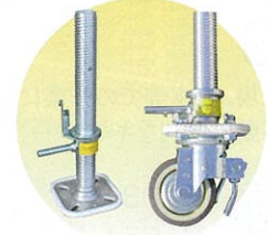
(C) ジャッキベース、ジョイント金具総てアルミ製とし、軽量化を重視し底面は建物、床等を傷つけない様にゴムライニングして有ります。又、取り付け取り外し簡単な自在キャスターもオプションとして用意しました。
