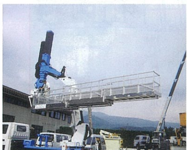
橋梁点検車のプラットフォーム
